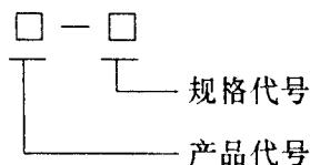
产品代号：YTM：表示筒式磨煤机用笼型异步电动机
